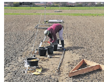
Mit Plexiglasröhren im Boden und einem rotierenden Scanner wird wöchentlich die Wurzeltiefe der Pflanzen beobachtet. Das Wägelysimeter im Hintergrund misst den aktuellen Wassergehalt des Gesamtbodens und bestimmt die Verdunstung.
